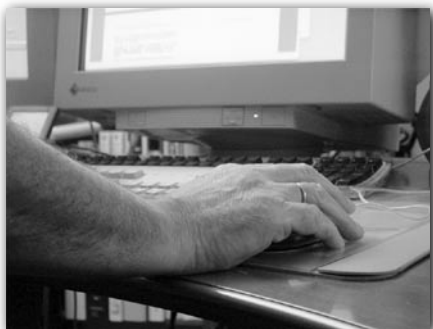
Verbiegung des Handgelenks bei der Mausbedienung – immer wenn die Unterarme nicht genau waagrecht ausgerichtet sind, kommt es zu einer Verdrehung des Handgelenks ...
