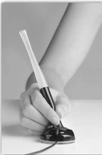
Aus dem inzwischen schon recht umfangreichen Angebot von ›Stiftmäusen‹ hier zwei Beispiele. Die Stiftmaus links ( www.ullmans.com ) wird gehalten wie ein Federhalter, um so die ›Platte‹ unten auf dem Tisch zu bewegen; integriert sind zwei Maustasten und ein ›Rollrad‹. Die Stiftmaus oben (I-Pen) wird mit der Spitze auf Tisch oder ›Mousepad‹ bewegt und kann mit ihrer integrierten Optik zugleich auch als Zeilen-Scanner und digitaler Notiz-/Zeichenstift verwendet werden ...
