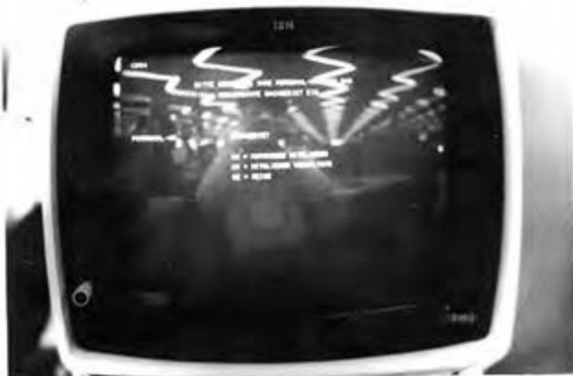
Abb. 4.28 Eine fortlaufende Reihe von Leuchtstofflampen spiegelt sich in einem Bildschirm wider und zerstört dessen Bild.
