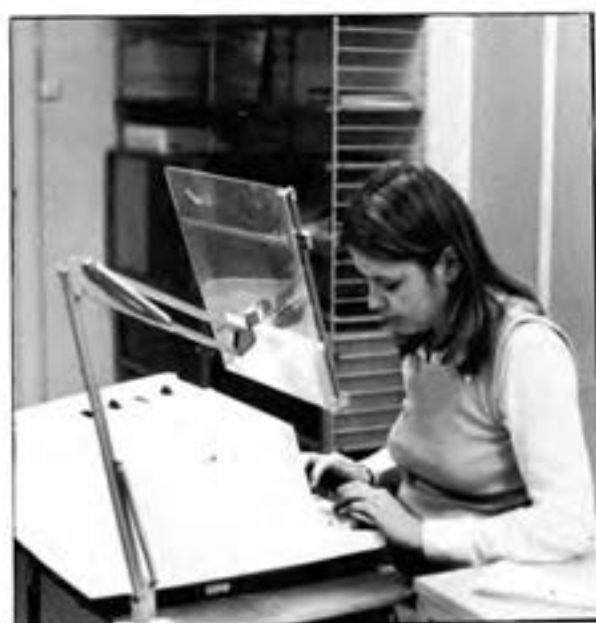
Abb. 4.13 Der Konzepthalter in diesem Beispiel ist durchsichtig und wenig stabil und verursacht außerdem noch Reflexionen. Ref. K. 26
