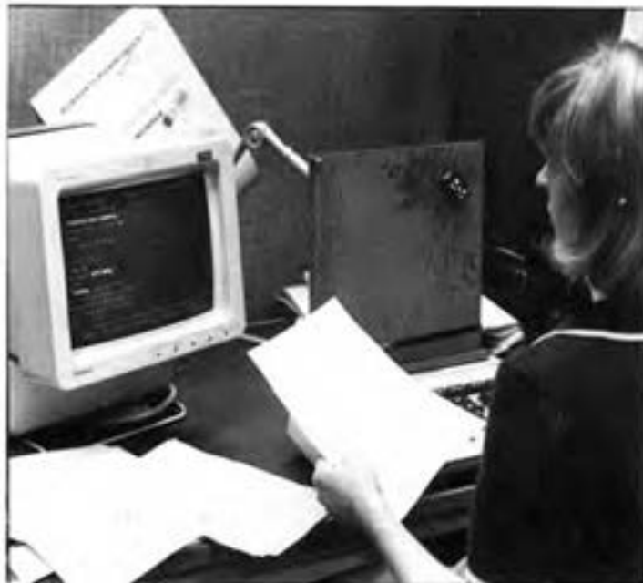
Abb. 4.14 Diese Art Konzepthalter ist günstiger. Mit einem Magneten wird das Manuskript am Halter befestigt. Ref. K. 26
