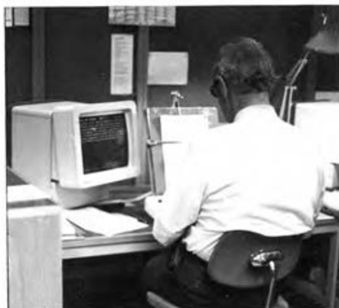
Abb. 4.12 Ein VDT mit abnehmbarer Tastatur. Bei diesem Beispiel sind Tastenfeld und Manuskript in der günstigsten Stellung, direkt vor dem Benutzer. Ref. K. 26
