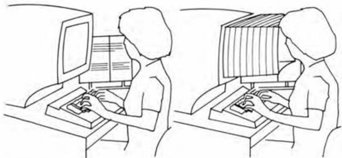
Abb. 2.38 Unter ungünstigen Lichtbedingungen kann eine Röhrenabschirmung Reflexionen vom Bildschirm verringern und den Bildkontrast verstärken. Die Verwendung von Röhrenabschirmungen unter Bürobedingungen ist jedoch eine extreme Maßnahme, da sie dazu zwingen, eine starre und oft ungünstige Haltung bei der Arbeit einzunehmen.
