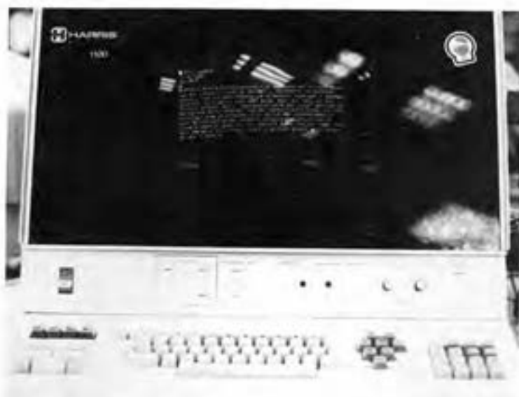
Abb. 2.33 Reflexionen, wie sie von der Oberfläche eines Polarisationsfilters erzeugt werden.
