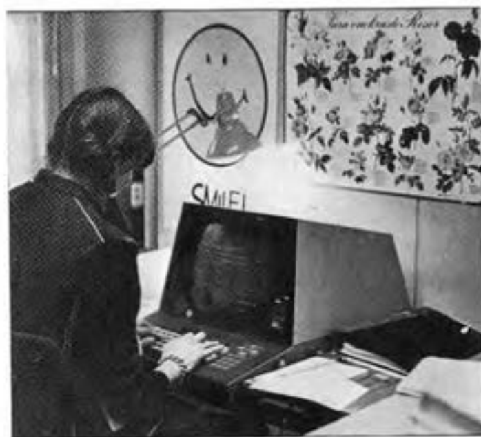
Abb. 4.21 Ein VDT mit fest angebaute Tastatur, die man im Interesse guter Bedienbarkeit in die Schreibtischplatte eingelassen hat. Leider ist nunmehr der Bildschirm zu niedrig, um ihn bequem betrachten zu können. Das führt zu der im Bild erkennbaren Nackenneigung. Ref. K. 26
