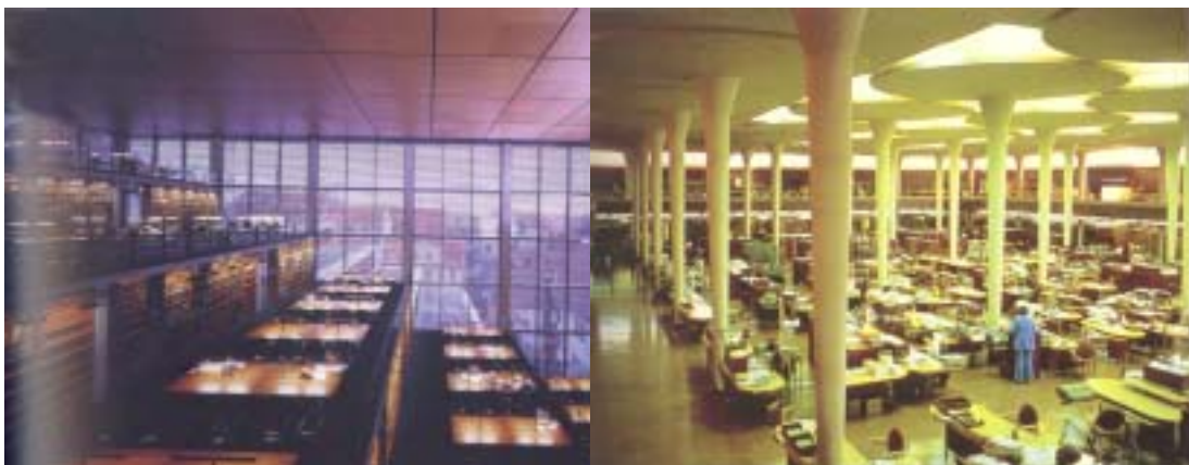
Bild E.27 Hallenförmige Räume und Reflexblendung Auf der linken Seite mit deutlich betontem seitlichen Lichteinfall machen sich Reflexe auf allen nicht vollständig matten Flächen störend bemerkbar (links, Tische und Decke), während dies bei entsprechend gestalteten Oberlichtern nur punktuell vorkommt (rechts, Fußboden auf der linken Seite). Die Reflexe auf den Tischen im linken Bild würden sich bei einer Decke mit Oberlichtern nicht mehr störend bemerkbar machen. (links /E.20/, rechts /E.37/)
